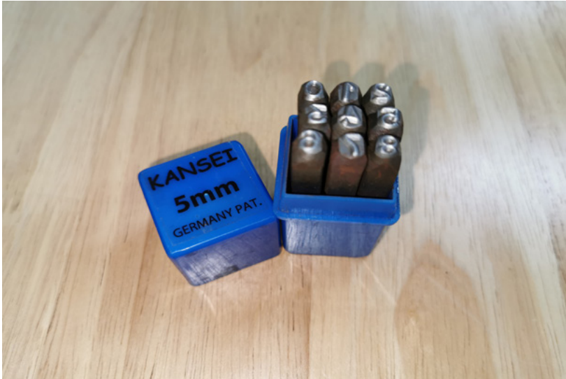
ภาพที่ 22 ตัวเลขบนเหล็กตอกเบอร์ ขนาดอักษร 5 มม.
