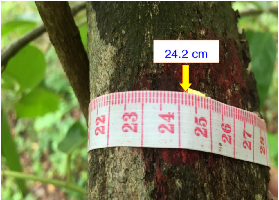
ภาพที่ 34 ตัวอย่างการใช้สายวัดและอ่านค่า กรณีนี้ค่าเส้นรอบวงเท่ากับ 24.2 เซนติเมตร
