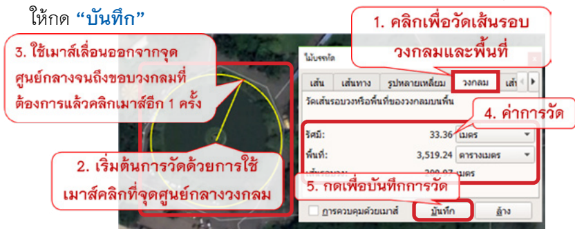
ภาพที่ 51 การใช้ไม้บรรทัดวัดเส้นรอบวงและพื้นที่วงกลมบนพื้น
