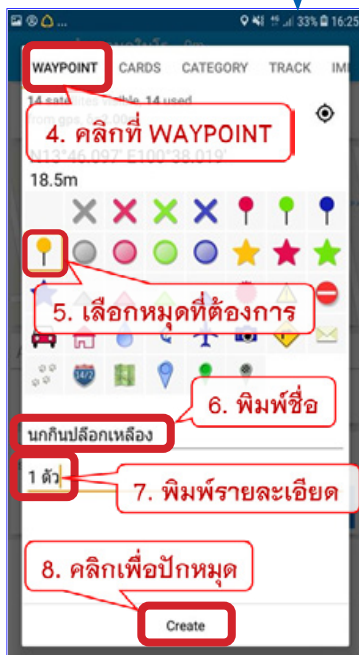
ภาพที่ 12 ลำดับขั้นตอนการปักหมุด (Waypoints) ใน GPS Essentials
